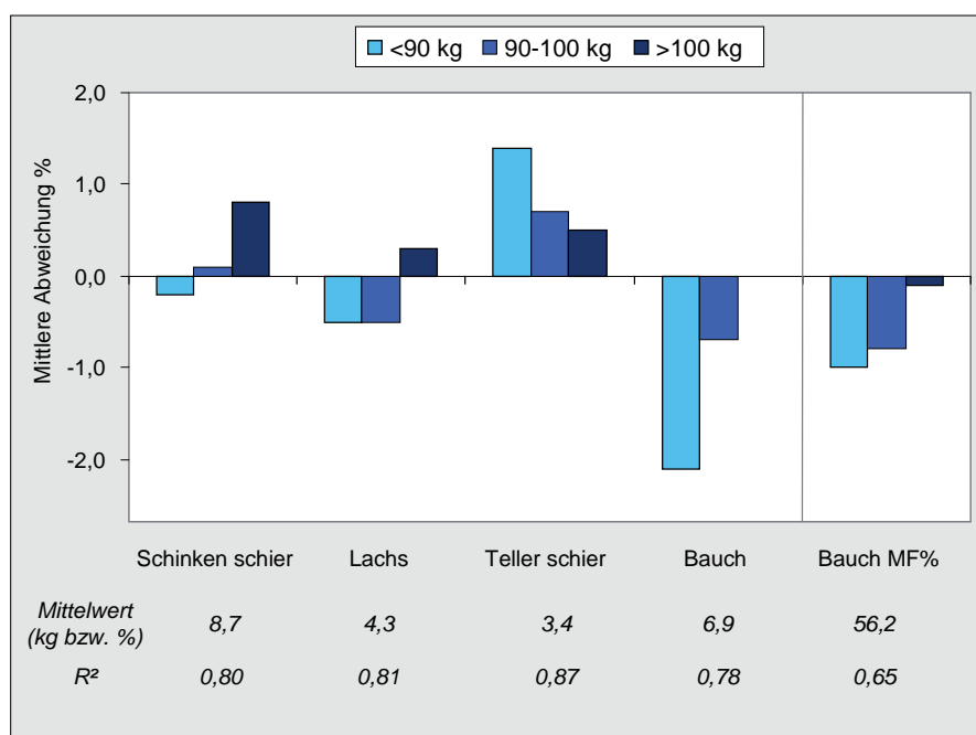
Abb. 11: Vergleich AutoFOM I und AutoFOM III im Feldversuch in zwei Schlachtbetrieben: Mittlere Abweichungen in den Gewichtgruppen (in % des Teilstückgewichtes bzw. Muskelfleischanteils; n_{<90} = 1804 , n_{90-100} = 3168 , n_{>100} = 1043 ), Mittelwerte der Teilstücke und Determinationskoeffizienten ( R^2 ) für die gesamte Stichprobe (n = 6015)
